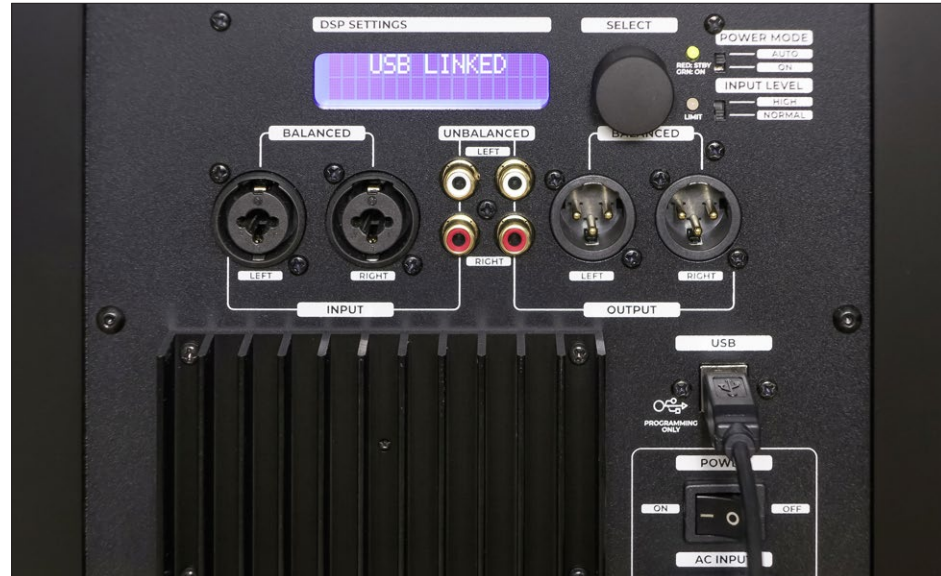
Das kombinierte Verstärker- und Steuerungsteil des Subs lässt sich in vielen Menü-Punkten auch über das „Select“-Stellrad und das Mini-Display einstellen, mittels PC ist dies jedoch bequemer.
